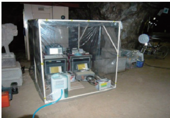
図5. データ収録装置。収録装置はビニールで囲った空間を作り、そこへ設置した。中には除湿機を置き、湿度を落とすことで安定して運転できるようになった。
