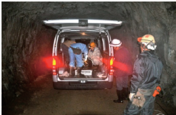
図4. ケーブル設置・撤収状況。車の後部にリールを乗せ、ケーブルを展開、回収した。
