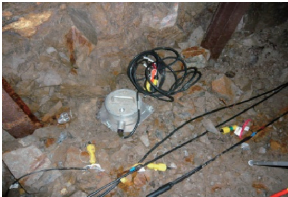
図3. 地震計設置状況。3成分地震計は10 mm厚のアルミプレート状に設置された。黒いケーブルがCDPケーブル。
